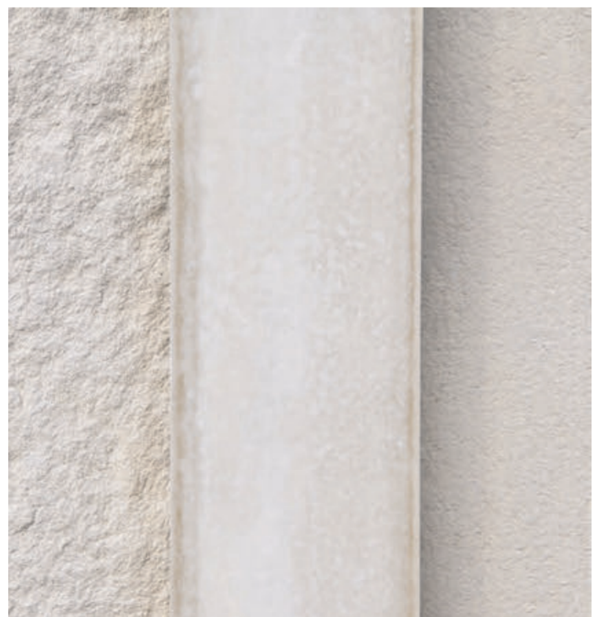
Für das Erdgeschoss stehen drei mögliche Fassadenvarianten aus Polyesterbeton zur Diskussion: Eine mit glatter Oberfläche (Mitte) sowie zwei mit unterschiedlich groben Oberflächenstrukturen.
